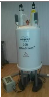
Спектрометр ЯМР Bruker 300
