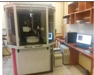
Рентгеновский дифрактометр Bruker Apex
