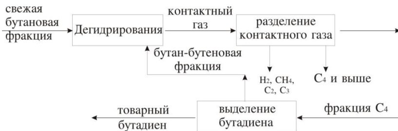
Блок схема производства бутадиена 1,3 одностадийным дегидрированием н.бутана
